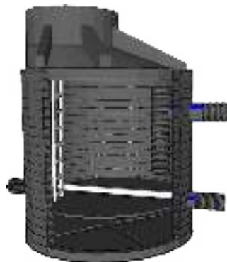
Типовой канализационный колодец FD SVT перепадный с трубчатым перепадом
